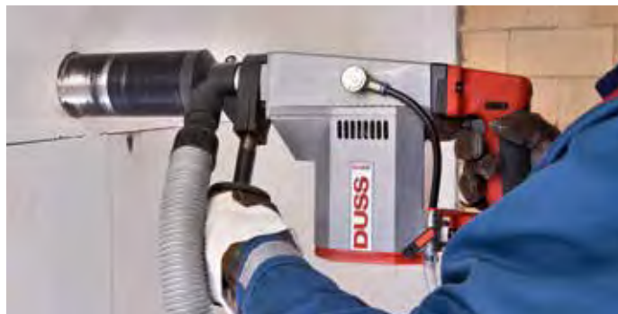
Vrtání otvorů pro elektroinstalaci za sucha do vápencového pískovce s odsáváním prachu
