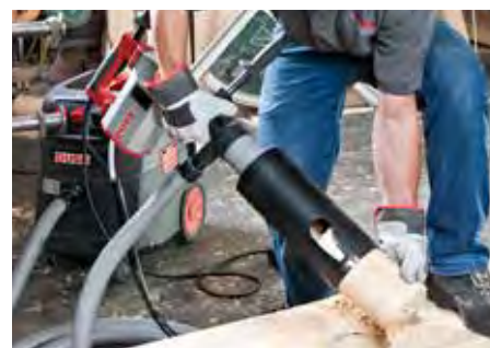
Vrtání do dřeva s odsáváním prachu – s ručním vedením
